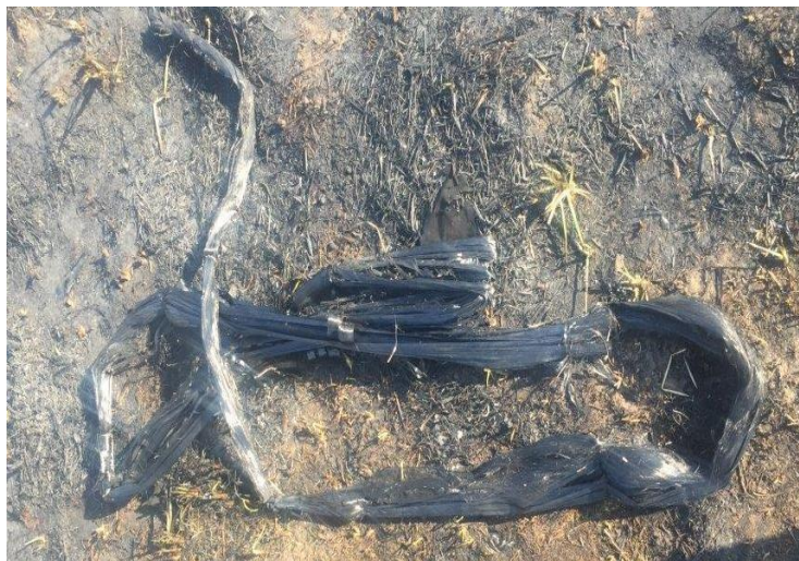
Углепластиковое удилище после прохождения электрического тока
